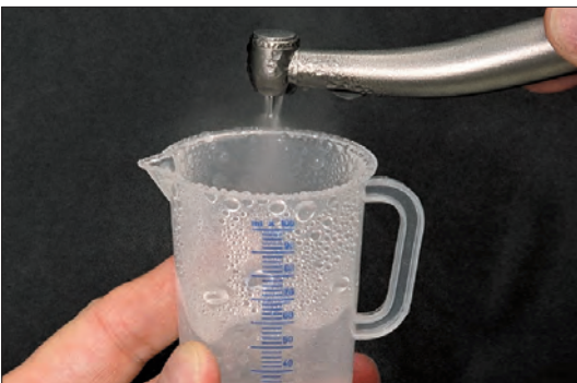
Auf Mindestmenge an Kühlwasser (50 ml pro Minute) prüfen. Check the water coolant flow with a minimum of 50 ml per minute. Vérifier le spray d'eau froide (50 ml par minute au minimum).
